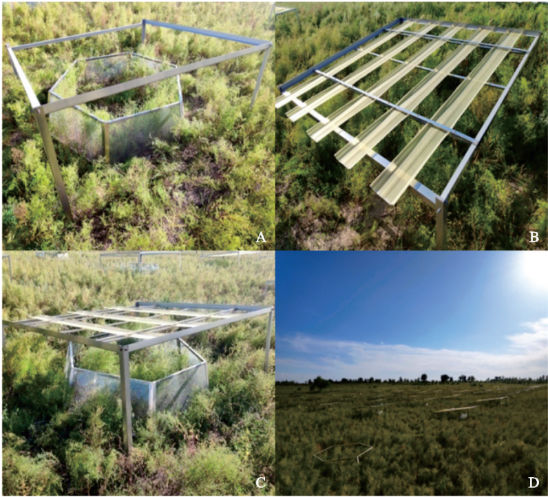
A. 增温装置;B. 降水减少装置;C. 增温×降水减少装置;D. 样地图。
